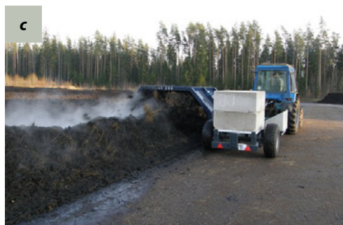
Joonis 4. Kompostiauna segamine: a – eestlaaduriga, b – kopp-purustiga ALLU, c – järelveetava pöörliiga COMPOST and WASTE Technology ST-300, d – liikurpöörliiga BACKHUS
