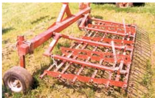
Vedrupiäke sobib hästi kevadiseks teraviljade äestamiseks. Lisaks seemneumbrohtude tõrjele vähendab äestamine veekadu mullast.
