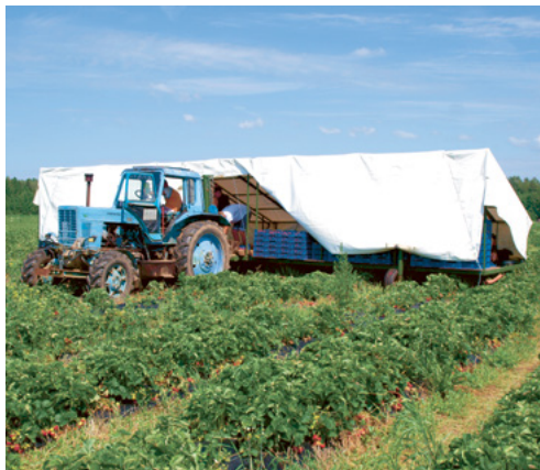
Foto 1. Traktori haakes platvorm, millel lamades on kergem taimi istutada, rohida või saaki koristada
