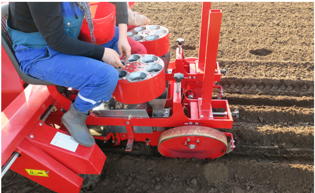
Foto 15. Karusselliga istutusmasin Patryk firmalt Weremczuk küüslaugu mahapanekul
