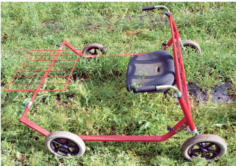
Foto 5. Soomlaste valmistatud aiavanker võimaldab tööd teha istudes, selle asemel, et kükitada või kummarduda
