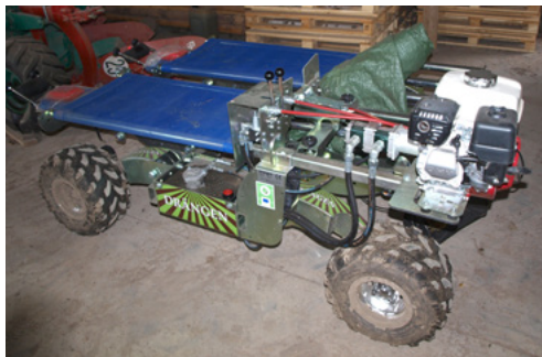
Foto 4. Sisepõlemismootoriga 4- ja 2-kohaline roomaja Drängen, vasakul olevale roomajale on talunik ise ehitanud lihtsa varikatuse
